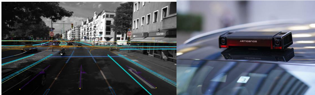
图 14: Atlatec 所制作的高精度地图与车载摄像头混合的结果。右: Artisense 的传感器系统
