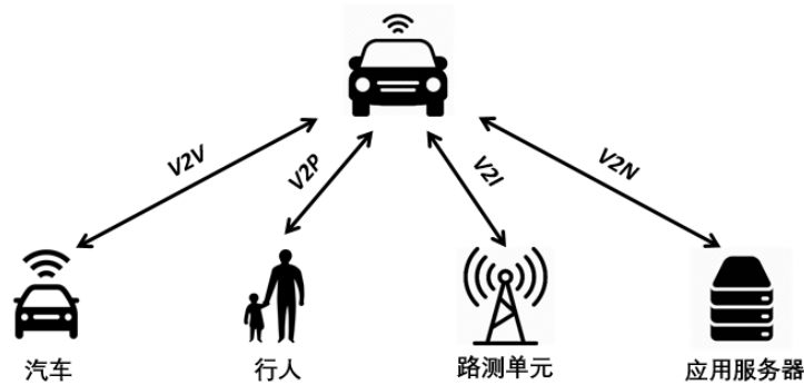
图 3. 四种 V2X 的应用支持类型示意图
