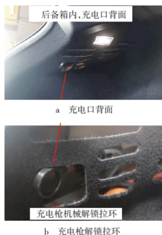
图9 某车型充电枪拉索位置示意图
