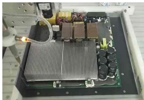
图5 40kW隔离风道灌胶充电模块自动灌胶生产过程
