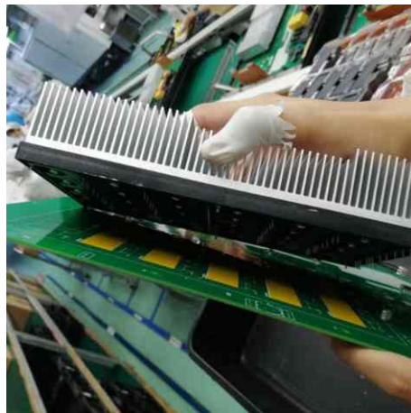
图4 30kW隔离风道灌胶充电模块半导体功率器件专利设计的密闭结构组件
